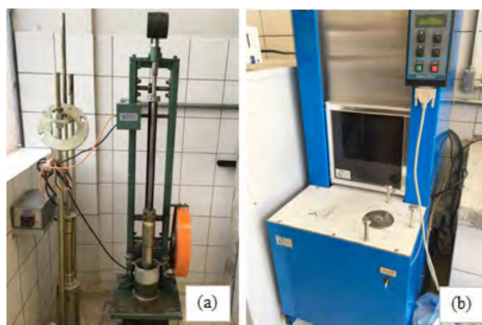
Figura 3 – (a) soquete Marshall; (b) compactador giratório Superpave.
