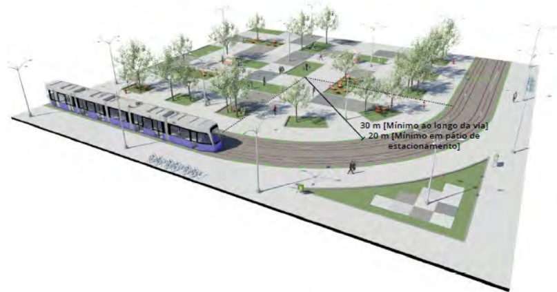
Figura 3 – Raio mínimo de curvatura para VLT's [10].
