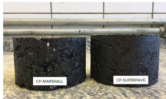
Figura 6 – Corpos de prova das misturas estudadas.
