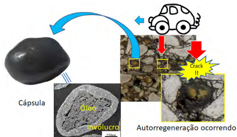
Figura 5 – Esquema de autorregeneração com cápsulas.
